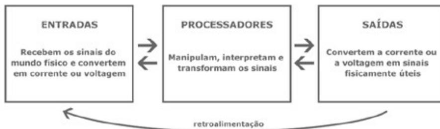
Como exemplo imaginamos um aparelho de TV. A entrada é um sinal recebido por uma antena ou um cabo. Os circuitos integrados do interior do aparelho extraem a informação sobre brilho, cor e som deste sinal. Os dispositivos de saída são a tela LCD, que converte os sinais eletrônicos em imagens visíveis, e as caixas de som, que emitem o som.
